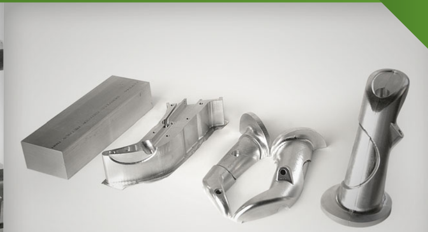
ÉTAPES D'USINAGE D'UNE MANETTE DE CONTRÔLE
